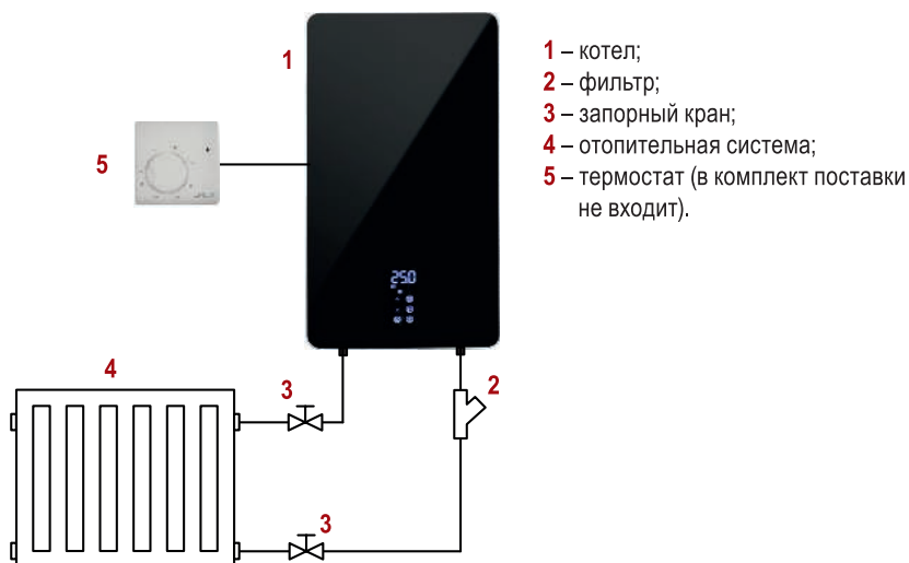
Рисунок 19 - Подключение термостата (в комплект поставки не входит)
